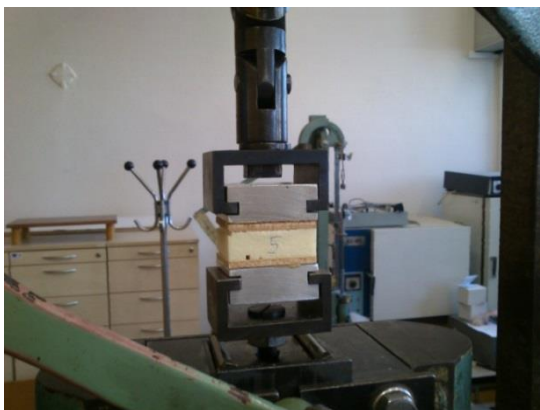
Obrázok 2: Trhací stroj LabTest 4.050 (LaborTech) s upnutou vzorkou
