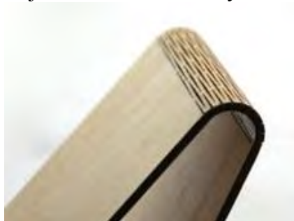
Obrázok 1 Preglejka perforovaná laserom za účelom zvýšenia tvárniteľnosti (Gasubasu, s. a.)
