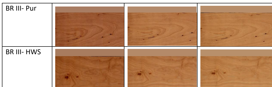
Obrázok 6 Povrchy brezového dreva termicky upraveného režimom III s povrchovou úpravou aj bez, počas expozície 30 a 60 dní. (Poznámka: BR – breza, bez PU – bez povrchovej úpravy.)
