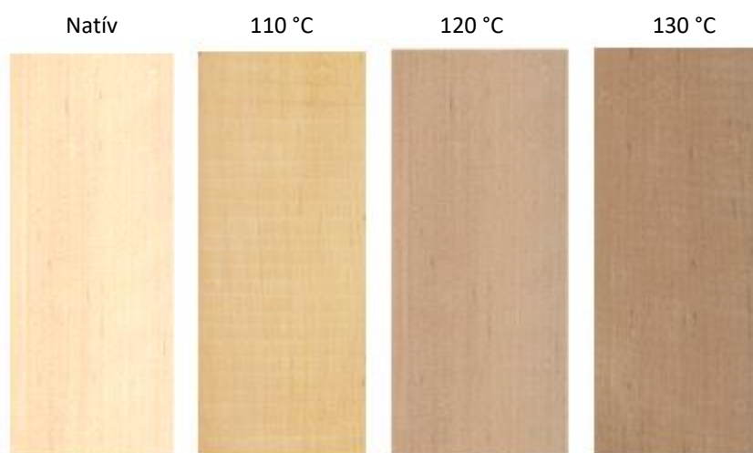
Obrázok 2 Farba jelšového dreva na ohobľovanom povrchu vysušeného nepareného a pareného dreva jednotlivými režimami parenia sýtou vodnou parou.
