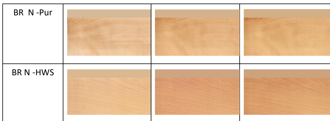
Obrázok 4 Povrchy brezového dreva bez termickej úpravy s povrchovou úpravou aj bez, počas expozície 30 a 60 dní. (Poznámka: BR – breza, N – bez termickej úpravy, bez PU – bez povrchovej úpravy.)
