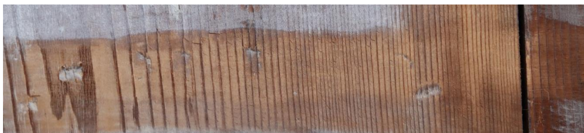
Obr. 8. Fotovzorka prvku vstupných dverí na schodisko zo zadnej strany – ročné kruhy boli zviditeľnené jemným zbrúsením a pretrením navlhčenou textíliou.
